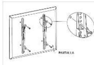
Coloque los brazos (B, C) del soporte en la parte trasera de la pantalla, el tornillo a utilizar dependerá del requerido por la pantalla a instalar. El soporte cuenta con 3 diferentes medidas de tornillos, en caso de que ninguno corresponda al requerido por la pantalla, deberá adquirirlo por separado. Las combinaciones de tornillo y rondana son de acuerdo al tamaño (I/F), (J/F), (K/G).
