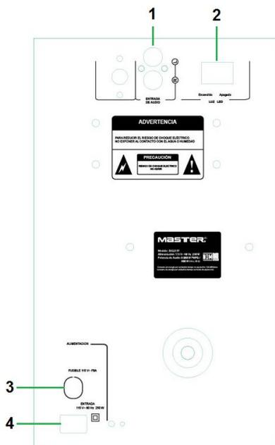
1. **ENTRADA DE AUDIO:** Entrada de audio auxiliar con conector RCA, para la conexión de equipos de reproducción de audio externos.
