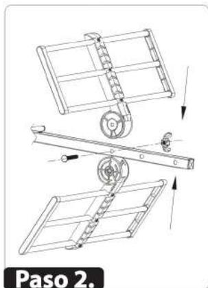
2. Coloque los reflectores quedando por detrás del dipolo, como se indica en paso 2.
