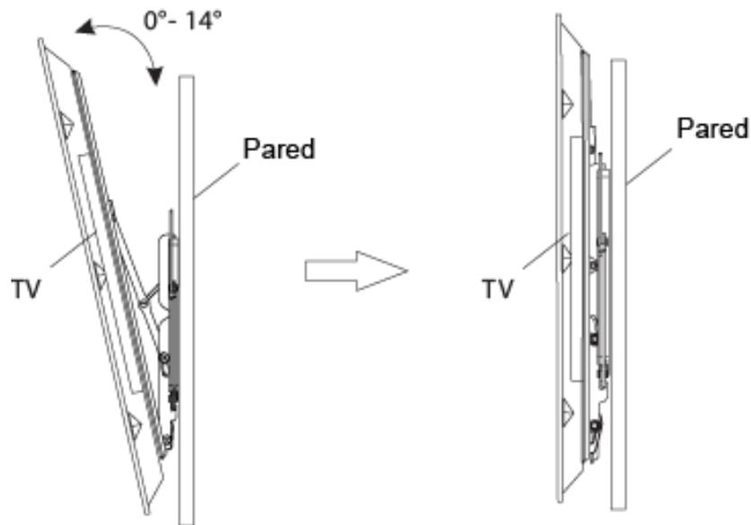
Elija los grados de inclinación para la pantalla y tener una buena visión de la imagen. El soporte está diseñado para proporcionar inclinación desde 0° hasta 14°
