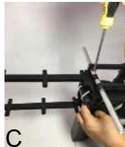
**Paso 6.** Inserte los reflectores en la parte trasera como se muestra en la figura (A), conecte los tubos como se muestra en la imagen (A), utilice el conector de plástico entre los dos tubos imagen (B), fije las láminas atornillándolas imagen (C).
