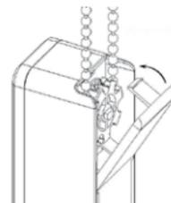
Abra la tapa del dispositivo y coloque la cadena alrededor del engrane y cierre la tapa.
