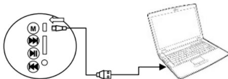
Se recomienda realizar la primera carga de la bocina de 2 a 4 horas, en cargas posteriores de 1 a 2 horas dependiendo el uso del equipo.
