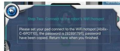
9. Cambie a la configuración WI-FI del iPad, encuentre el nombre de punto de acceso del robot y de clic para conectar. Pegue la contraseña copiada y conecte el iPad al punto de acceso del controlador, como se muestra en la siguiente imagen.
