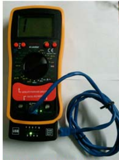
PRUEBA DE CABLE DE RED CON CONECTOR RJ45 LED INDICADOR DEL 1 AL 8.
